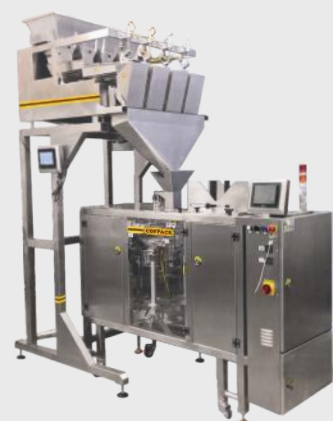
Linia pakująca: COFFPACK DOYPACK C 160 U + DWL 4 + stelaż
