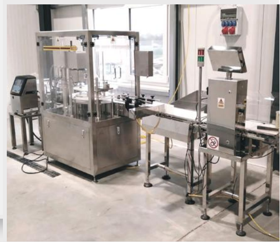
Linia do pakowania preparatów białkowych w puszki/tuby AZP/S 30 + VJ 1280 + KW 3000
