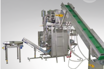
Linia pakująca: Dozownik do kapusty z podajnikiem DKK 1000 + COFPACK P/S 60/500 + OGT/S 300 + stół obrotowy
