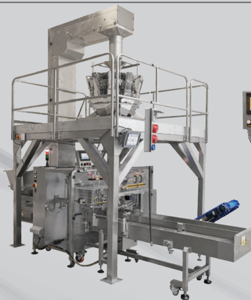
Linia pakująca: Automat pakujący COFPACK DOYPACK C 360 SC Box + DWK/W 10 + PWK 2000/2500 + PRZ 3750
